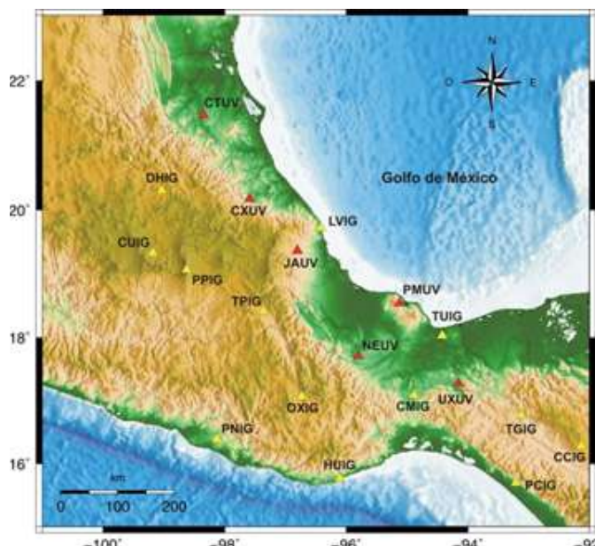
Figura 2. Mapa con la distribución de estaciones de la red sísmica de Veracruz (triángulos rojos) en el que se observa el complemento de la cobertura de la red del SSN (triángulos amarillos) en la zona del Golfo de México.
