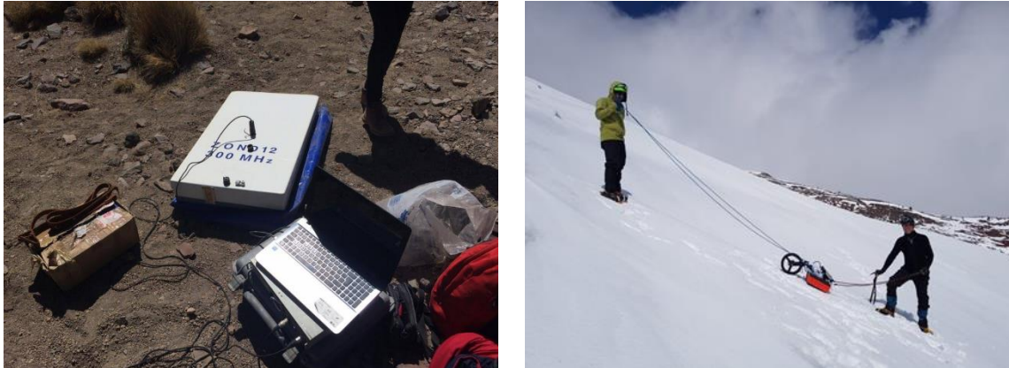
Figura 3. Fotos tomadas por Román Gutiérrez Anguiano (izq.) y Marco A. Morales Martínez (der.) de los dos tipos de Georradar empleados en la zona del albergue (izq.) y sobre el glaciar (der.).
