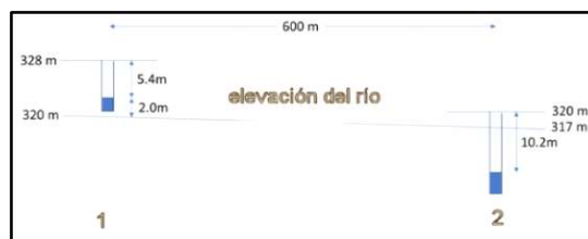
Figura 5 Esquema que muestra la relación entre los dos pozos que se encuentran en el área de estudio
